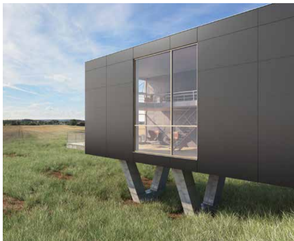
Onze nieuwe WRAP Premium bestaat uit aluminium profielen die zeer eenvoudig te bevestigen zijn. De WRAP Premium wordt gecombineerd met onze ALU50 TG PIR-isolatieplaten.
