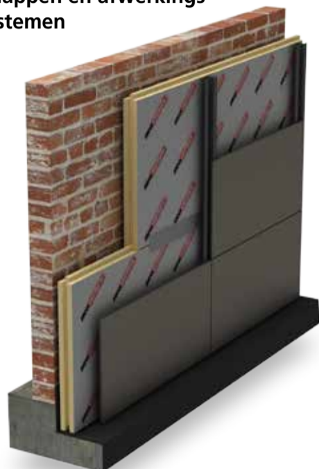
Onze nieuwe WRAP Premium bestaat uit aluminium profielen die zeer eenvoudig te bevestigen zijn. De WRAP Premium wordt gecombineerd met onze ALU50 TG PIR-isolatieplaten.
